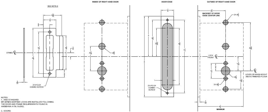
REINFORCEMENT IS REQUIRED PER ANSI A115.1-1991.
