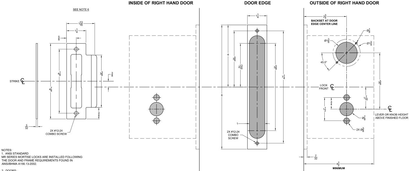
REINFORCEMENT IS REQUIRED PER ANSI A115.1-1991.
